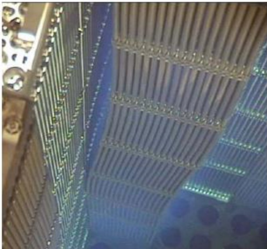
Abb. 5: Beispiel für ein verformtes Brennelement /U 20/
