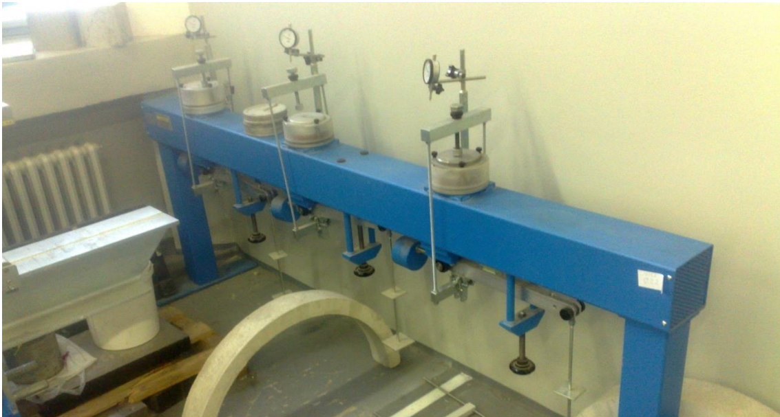
Abb. 6.4 Drei Ödometer auf einer Trägervorrichtung (nach /ŠOB 12/)
