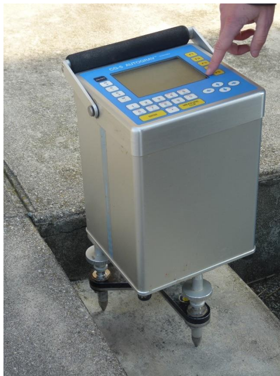
Abb. 4.3 Foto eines tragbaren Gravimeters (nach /SAN 18/)
