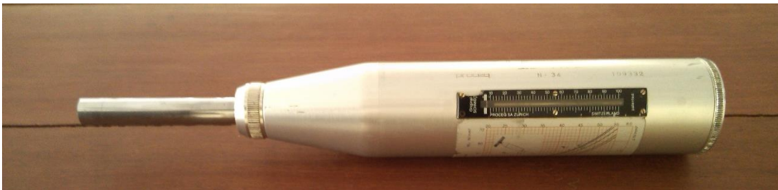
Abb. 6.3 Ein Rückprallhammer (nach /ARJ 13/)
