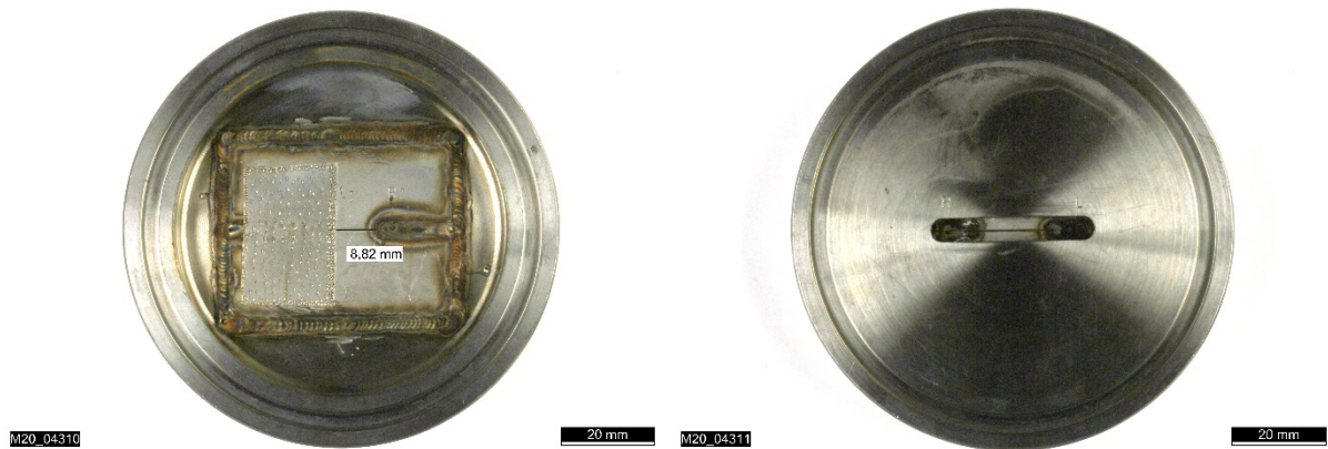
Abbildung 3.33: Übersichtsdarstellung der Eintrittsöffnung (links) und Austrittsöffnung (rechts) von Versuchskörper 010T001
