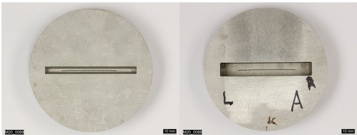
Abbildung 3.22: Aufnahme der Eintritts- (links) und Austrittsöffnung (rechts) von Versuchskörper R4
