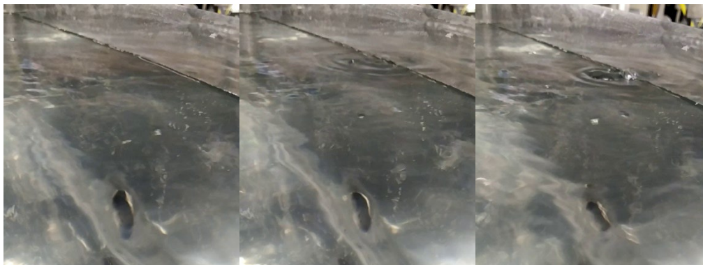
Abbildung 3.49: Blick auf die Wasseroberfläche des Behälters zu drei ausgewählten Zeitpunkten mit aufsteigenden Dampfblasen, die auf unvollständige Kondensation im Wasserbehälter hinweisen
