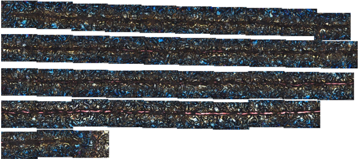
Abbildung 3.25: Montage von lichtmikroskopischen Aufnahmen des gesamten Risses in R4 auf der Eintrittsseite
