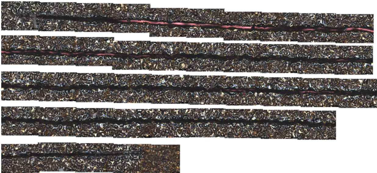
Abbildung 3.26: Montage von lichtmikroskopischen Aufnahmen des gesamten Risses in R4 auf der Austrittsseite
