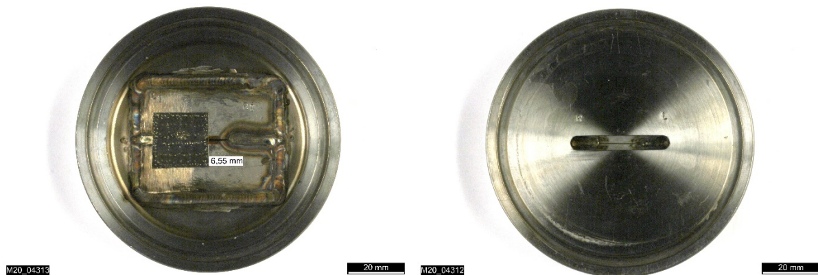
Abbildung 3.37: Übersichtsdarstellung der Eintrittsöffnung (links) und Austrittsöffnung (rechts) von Versuchskörper 020T001
