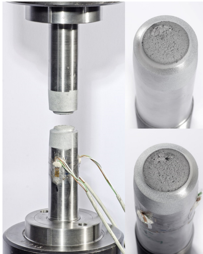
Bild 4.6: Probe am Versuchsende sowie Großaufnahmen der Bruchflächen
